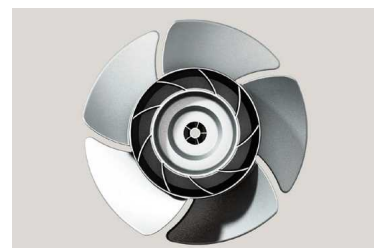
【ハイブリッドファン】 直進性の高い風をつくる「外周翼」、触媒フィルター・オゾンユニットからの風をしっかり引き込み一定濃度のオゾンエアを送り出す「内周翼」を合わせたハイブリッド構造のファンを採用
